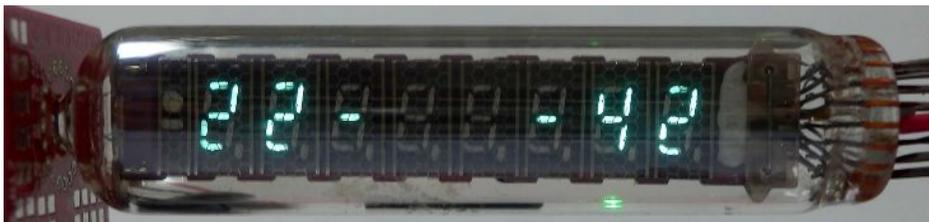
分の2桁を設定します。(点滅している2桁の所、上の写真では消えている所)
