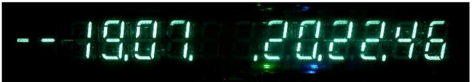
日の2桁を設定します。(点滅している2桁の所、上の写真では消えている所)
