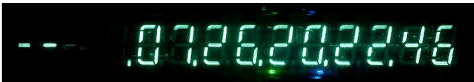
年の下2桁を設定します。（点滅している2桁の所、上の写真では消えている所）
