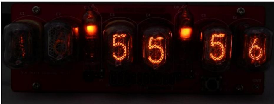
時の2桁を設定します。(点滅している2桁の所、上の写真では消えている所)
