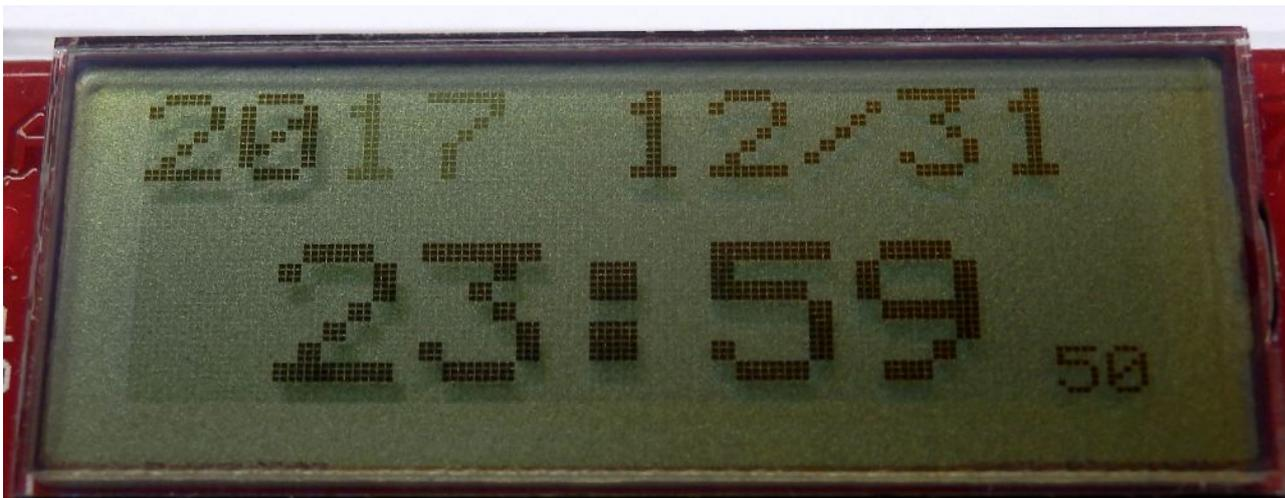
年部分（薄く17を表示している所）が点滅していますので違っていたら、右側スイッチを押して正しい年にします。
