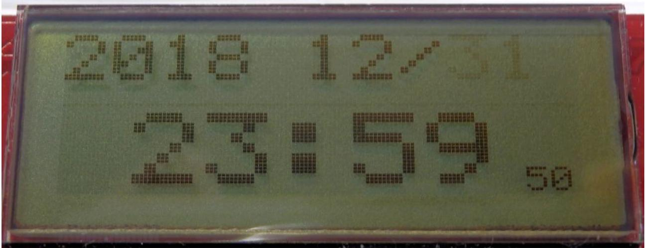
点滅が日部分（薄く 3 1 を表示している所）になりますので、右側スイッチで日を合わせます。その後、左側スイッチをクリックして時調整にします。
