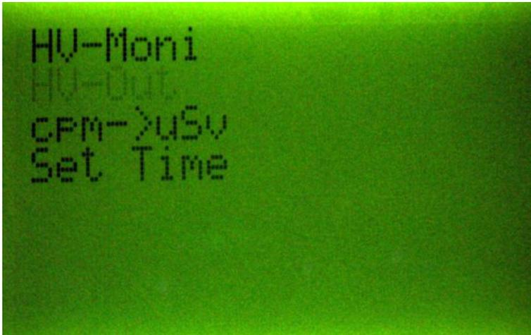
4つのモードに対応する文字が点滅しますので、左側押しボタンスイッチを押して目的のモードを点滅させてから 右側押しボタンスイッチを押してそのモードの動作を行ってください。
