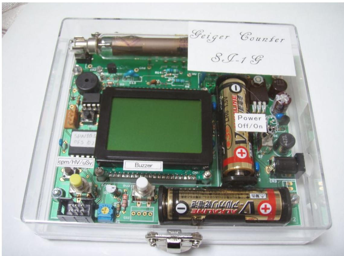
この機器は ガイガーミュラー管「SI-1G」を使用して  $\gamma$ 線量を計測します。
